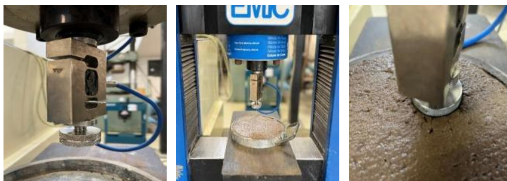
Figura 4: Célula de carga de 500N com punção circular de 25mm de diâmetro (à esquerda); arranjo do ensaio de squeeze flow com amostra abaixo do punção (ao centro) e amostra puncionada (à direita)
