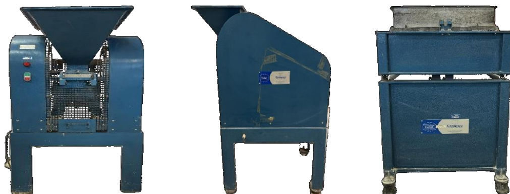
Figura 2: Moinho de mandíbulas utilizado para reciclagem dos blocos de cerâmica vermelha: vista frontal (à esquerda) e vista lateral (ao centro). Peneirador mecânico (à direita)
