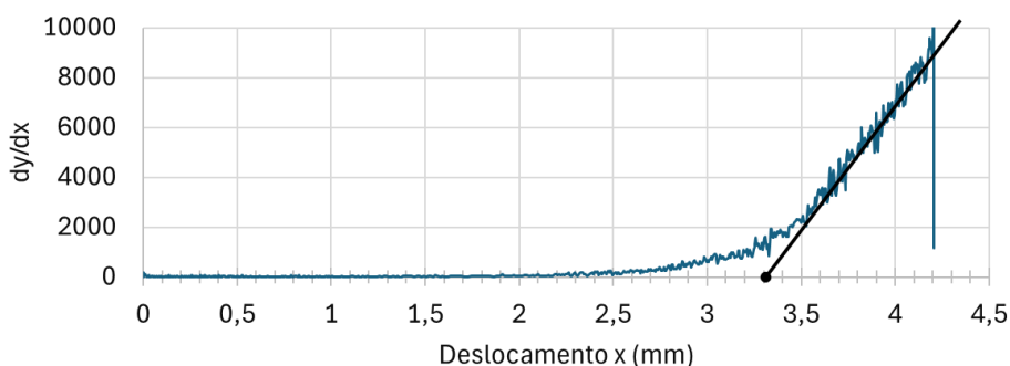
Figura 7: Exposição do método de determinação do deslocamento do ponto inicial do trecho de strain hardening
