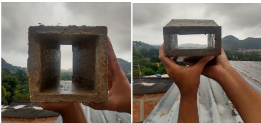
Figura 3 e 4: Cobogó em concreto produzido por Melo (2022). Fonte: MELO, 2022.
