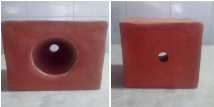
Figura 1 e 2: Cobogó em argila produzido por Santos (2017). Fonte: SANTOS, 2017.
