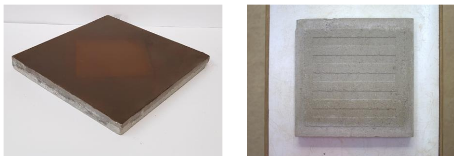
Figura 4: Ladrilho hidráulico produzido a partir do (RAB2-25% no interior da peça) e (RAP2-50% no exterior da peça)
