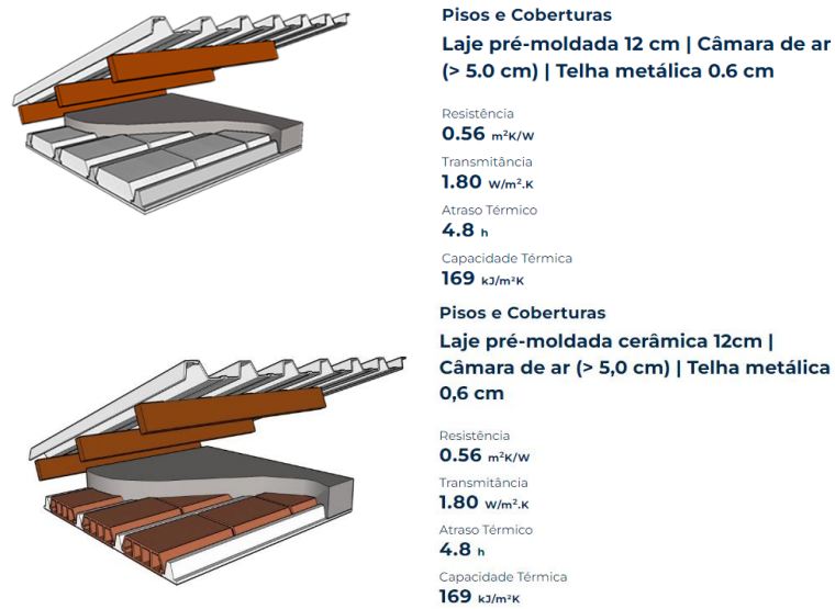
Figura 7: Dados de desempenho térmico para telhados metálicos.
