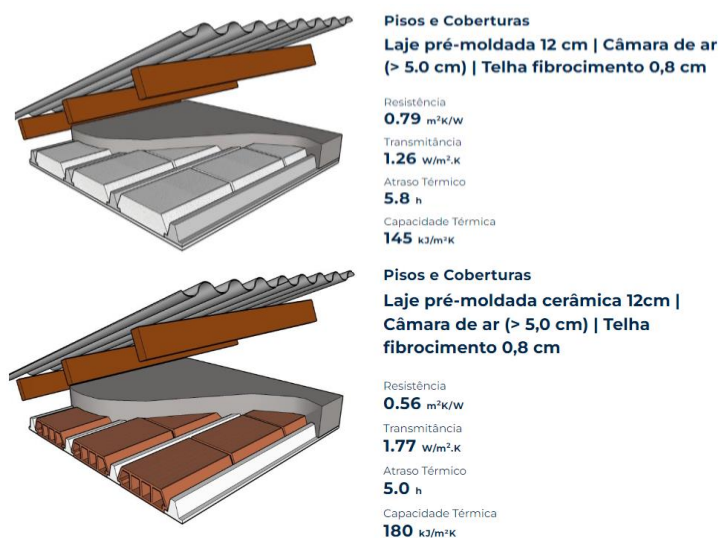
Figura 6: Dados de desempenho térmico para telhados de fibrocimento.
