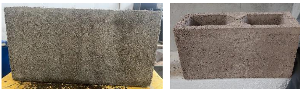
Figura 9 – Análise Visual dos Blocos Natural e Reciclado.
