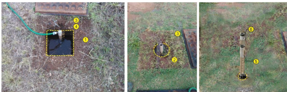
Figura 3: Estruturas de campo utilizadas nos diferentes ensaios para a determinação da taxa de infiltração do solo (cava rasa, poço a trado e infiltrômetro de mini-disco poroso).
