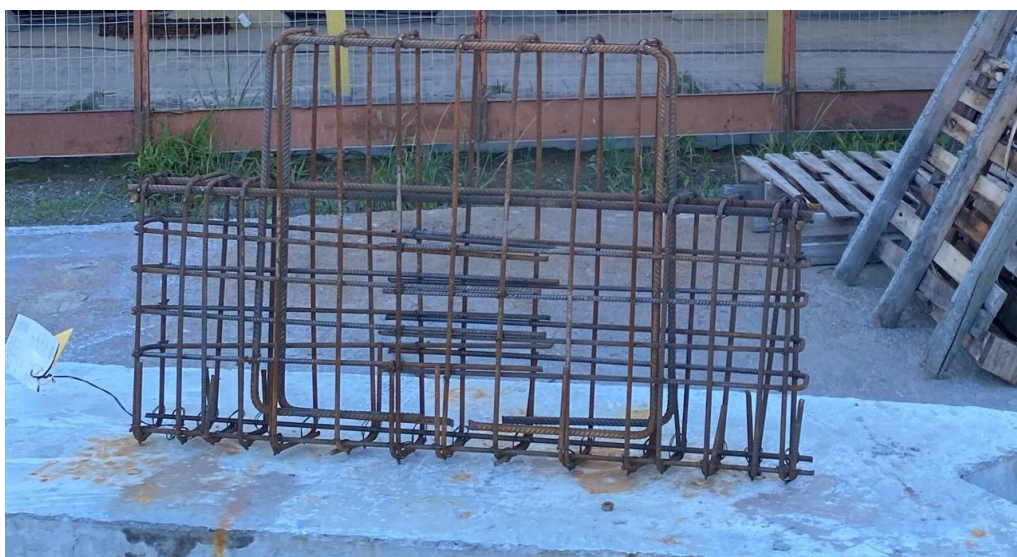
Figura 3 – Exemplo de armadura utilizada para geração de modelos virtuais
