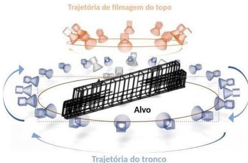
Figura 1 - Esquema do percurso das câmeras por videogrametria
