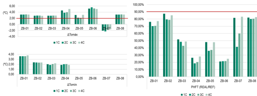
Figura 7 – Dados para o PHFTUH, \Delta T_{\text{omáx}} e \Delta T_{\text{omin}} comparativo entre o modelo com telha de fibrocimento para o cenário climático de 2080 e o modelo de referência.
