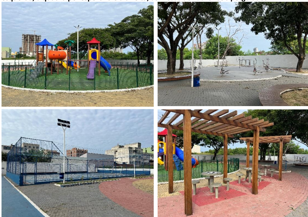
Figura 9: Equipamentos fixos na Praça do Jockey. Na parte superior, à esquerda o playground em plástico rotomoldado, e à direita academia popular em aço inox. Na parte inferior, à esquerda, a quadra poliesportiva e à direita, as mesas de xadrez sob pergolados.
