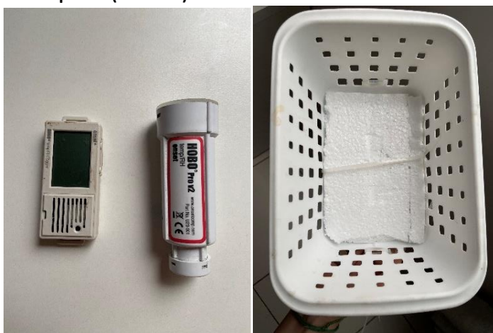
Figura 4: Sensores para medição de temperatura do ar HOBO UX 100-011 e HOBO Pro V2 (à esquerda); Cesta com isolamento para proteção dos equipamentos externos contra intempéries (à direita)
