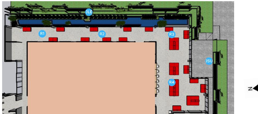
Figura 5: Pontos de coleta da Temperatura do ar e Umidade relativa externas e internas à recepção
