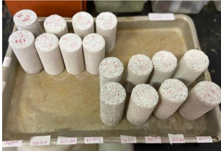
Figura 12 - Amostras após ataque ácido
