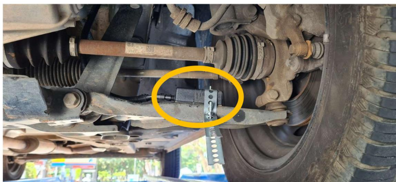
Figura 6: Instalação de sensor acelerômetro embarcado em automóvel
