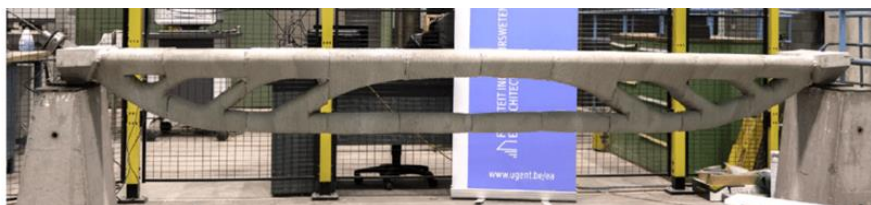
Figura 1: Impressão 3D de uma viga de concreto protendido, projetada por otimização topológica.
