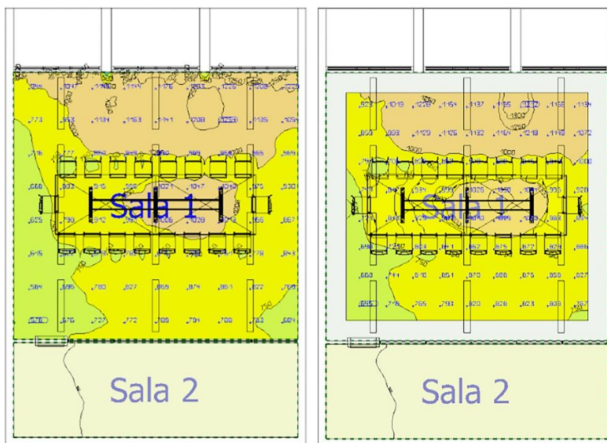
Figura 5 – Gráfico de simulação Dialux Evo relativo à luz elétrica a partir de luminárias LED + luz natural de inverno no Rio de Janeiro
