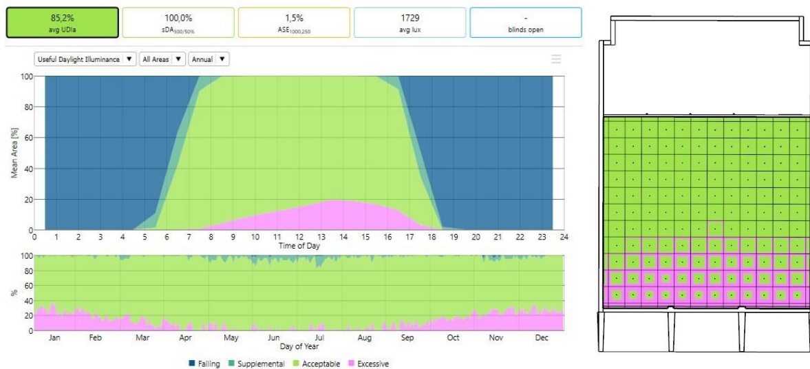
Figura 2: Análise de UDA através do plug-in Climate Studio para o software Rhinceros
