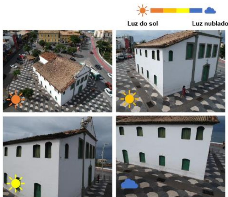
Figura 8: Sequência de “takes” para a fotogrametria de posições semelhantes das fachadas, mas com iluminações distintas.
