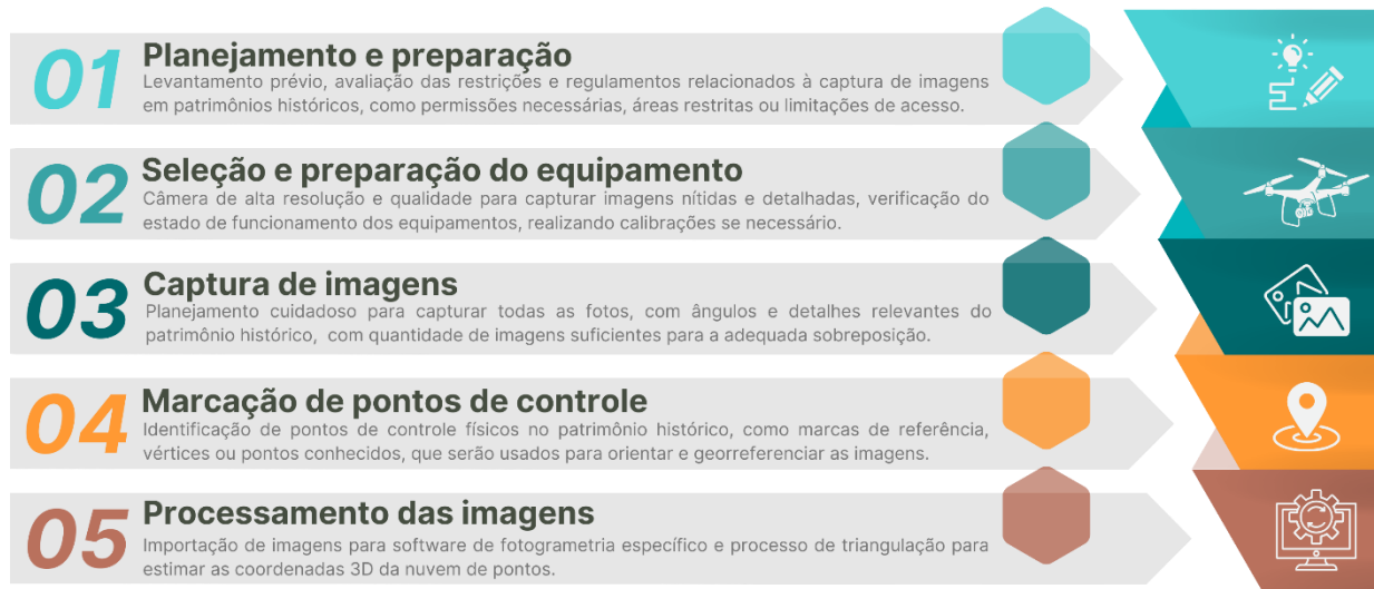
Figura 2: Planejamento e preparação para a fotogrametria
