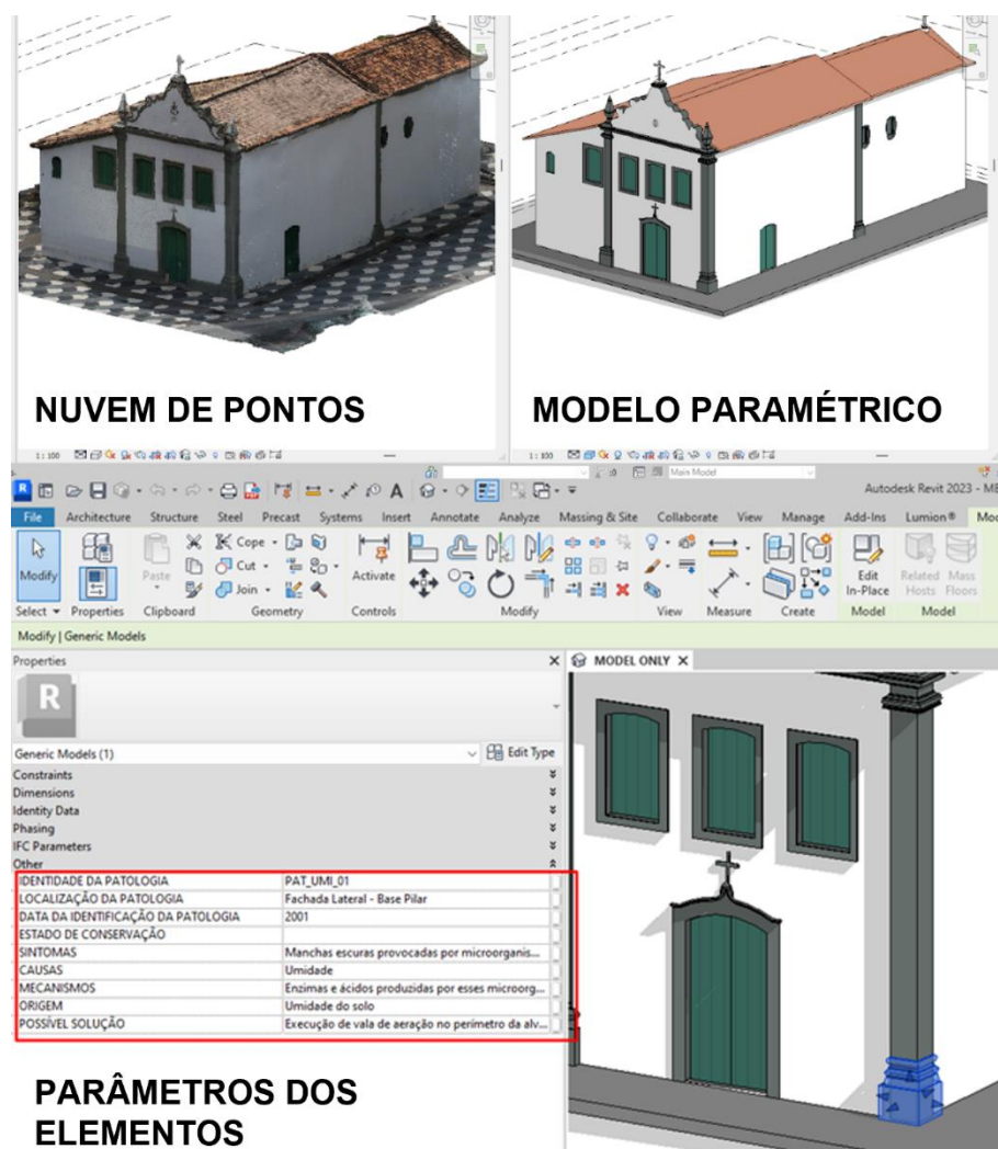
Figura 4: Modelo informacional HBIM e suas versões em nuvem de pontos, digital e paramétrico
