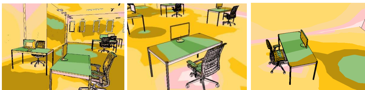
Figura 12: Cores 3D mostrando os níveis de iluminância de 500 lx nos planos de trabalho (em verde).
