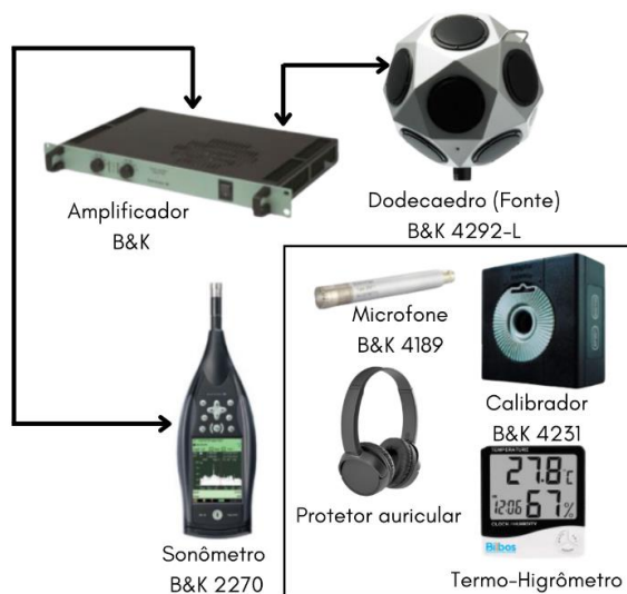
Figura 6: Cadeia de medição adotada de medição de tempo de reverberação
