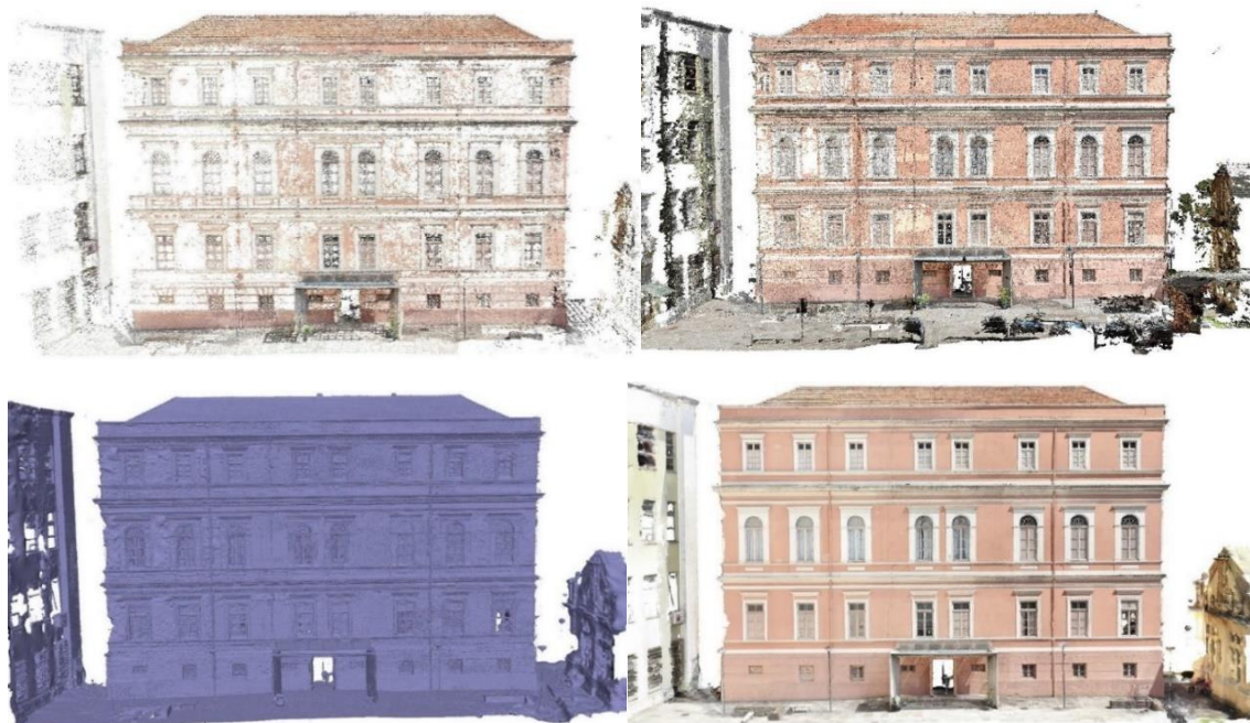
Figura 5 – Etapas de renderização da fachada sudeste no software Metashape ®. Sparse Cloud (à esquerda acima); Dense Cloud (à direita acima); Mesh Sólido (à esquerda abaixo); Textured Mesh (à direita abaixo).
