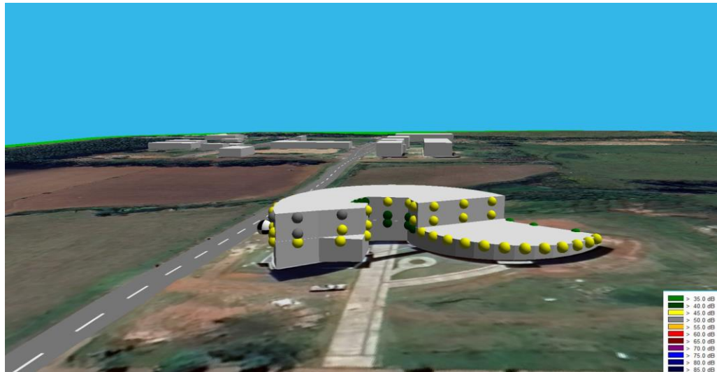
Figura 6: Modelo tridimensional, com receptores para cálculo dos níveis de ruído incidentes nas regiões das fachadas do Museu do Conhecimento, no CadnaA
