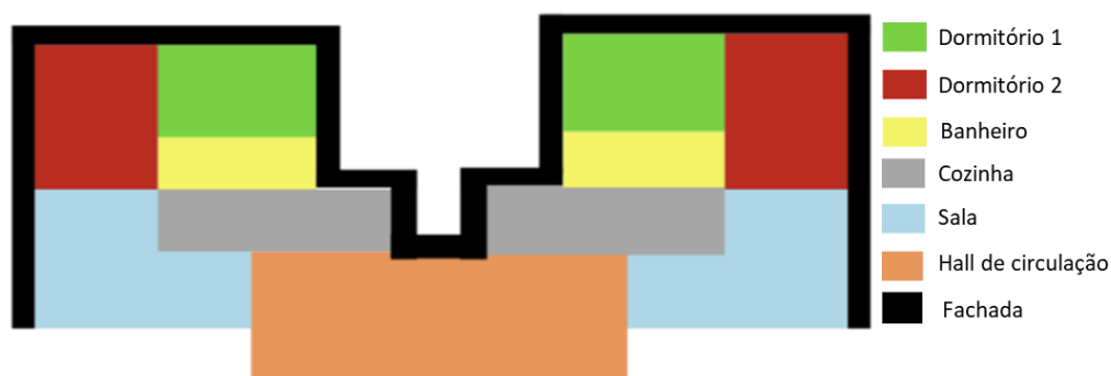
Figura 2: Distribuição dos ambientes para execução de fôrmas
