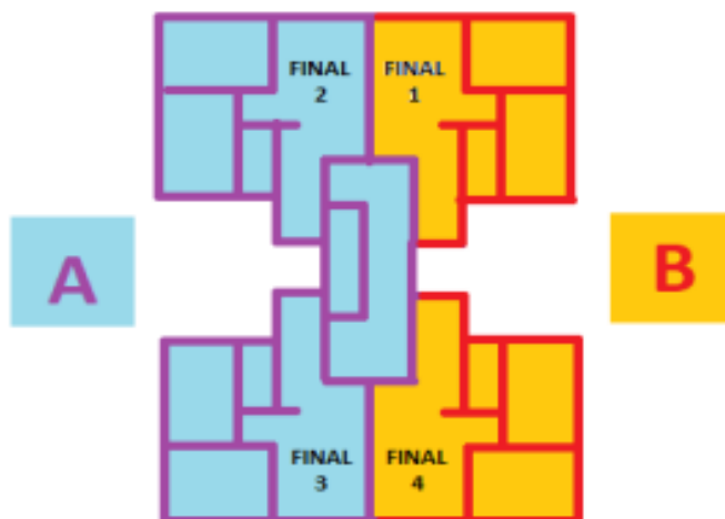
Figura 3: Ciclos de concretagem e montagem das fôrmas
