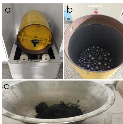
Figura 1 - Moinho de bolas (a,b) e cinza após a moagem (c)
