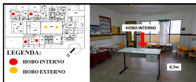
Figura 3- Localização dos HOBOS nas salas de aula.
