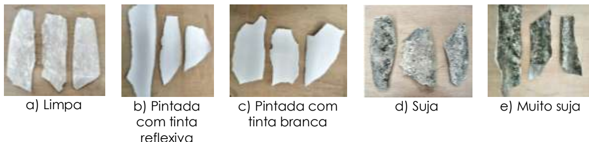
Figura 1 – Amostras utilizadas no ensaio de refletância
