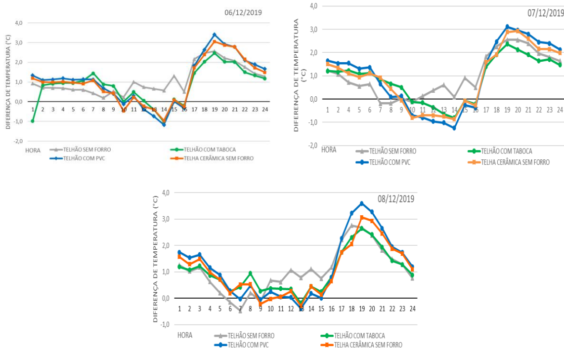
Figura 7 – Diferença de temperatura do ar ( ^\circ\text{C} ) registradas no interior das células-teste comparadas a temperatura externa nos dias 06 a 08 de dezembro de 2019
