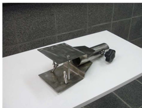
Figura 5 - Detalhe da base de fixação dos piranômetros em chapas paralelas
