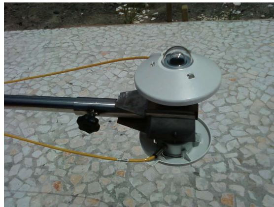
Figura 8 - Detalhe do posicionamento dos piranômetros
