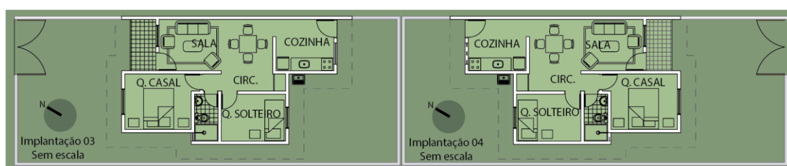
Figura 2 – Planta-baixa da UH original
