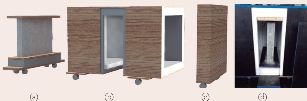
Figura 1. Compartimentos da câmara: (a), Suporte com rodízio dos painéis, (b) Câmara, (c) Módulo de aquecimento, (d) Painel inserido na câmara.
