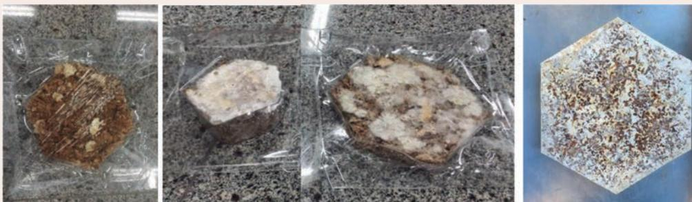
**Figura 5.** Transferência dos substratos para as fôrmas, crescimento do micélio e material já crescido.
