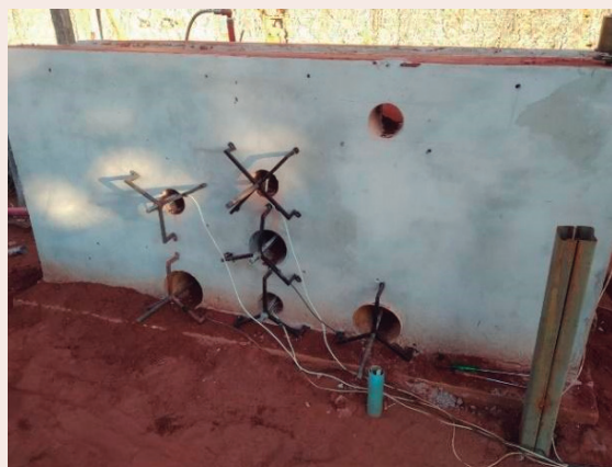
Figura 3. Suportes metálicos fixados no molde indeformável
