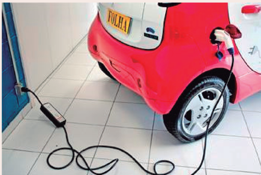
Figura 1. Exemplo de veículo elétrico sendo recarregado em tomada elétrica comum, que estão disponíveis na totalidade dos imóveis que possuem alimentação de energia elétrica.
