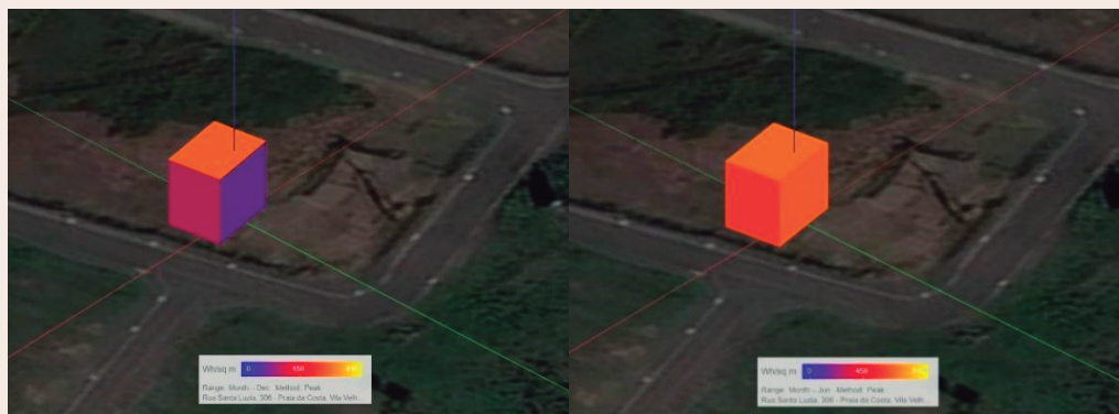
Figura 6. Estudo radiação na fachada no verão, Formit®, 2021.
