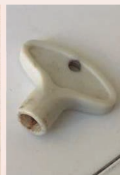
Figura 8. Chave acionadora de torneiras: edifício BI.
