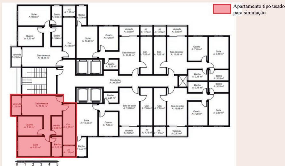
Figura 2. Planta baixa pavimento tipo e apartamento analisado.
