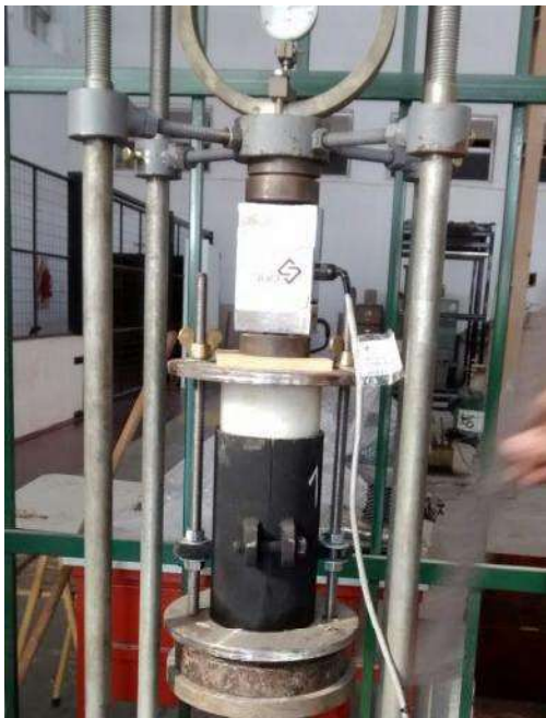
Figura 1. Moldeo por compresión en prensa
