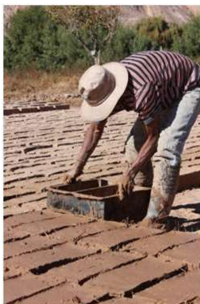
Figuras 2 y 3. Proceso de producción de adobes en Maimará (Fotografías: J. Tomasi)
