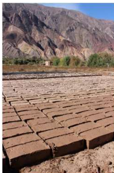
Figuras 2 y 3. Proceso de producción de adobes en Maimará (Fotografías: J. Tomasi)
