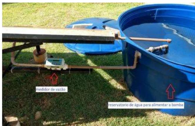
Figura 4. Detalhe do sistema de monitoramento da eficiência da placa.
