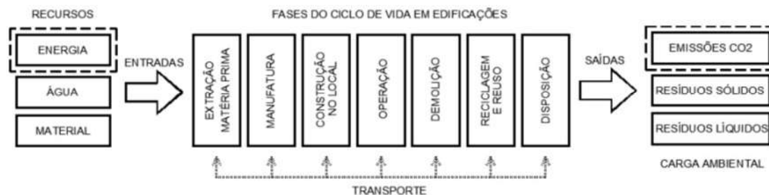
Figura 1. Fluxograma - fases do ciclo de vida de uma edificação, principais recursos consumidos e cargas ambientais liberadas, Adaptado de CHAU; LEUNG; NG, 2015.
