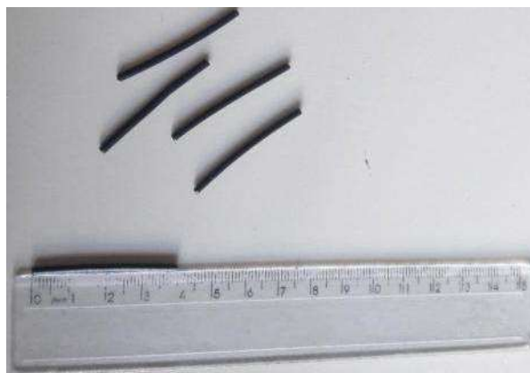
Figura 1 – Fibras de PP extrusadas com 4 cm de comprimento
