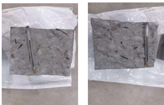
Figura 6 e 7 – Corpos de prova pós rompimento do composto pelo ensaio de tração na flexão.
