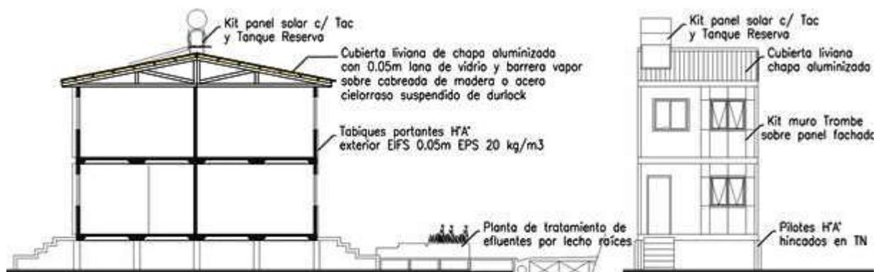
Figura 3: Corte y vista del dúplex de 64 m<sup>2</sup>. Fuente Propia.
