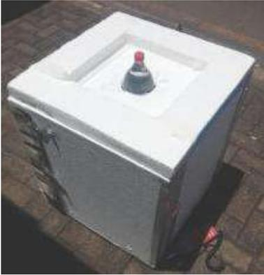
Figura 4. Modelo com a garrafa PET fixada na cobertura móvel.
