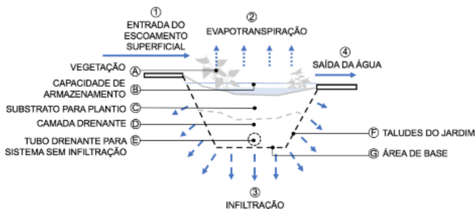
Figura 2: Corte exemplificado de uma célula de biorretenção. Fonte: Pereira et al. (2025, p. 101).
