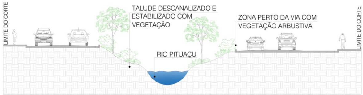
1 – Corte A: trecho renaturalizado com talude vegetado em ambas as margens.
