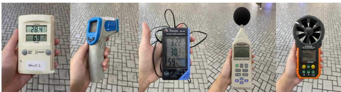
Figura 1: instrumentos utilizados nos levantamentos microclimáticos: Termo-higrômetro 1, Termômetro infravermelho, Termo-higrômetro 2, Medidor de ruído e Anemômetro.
