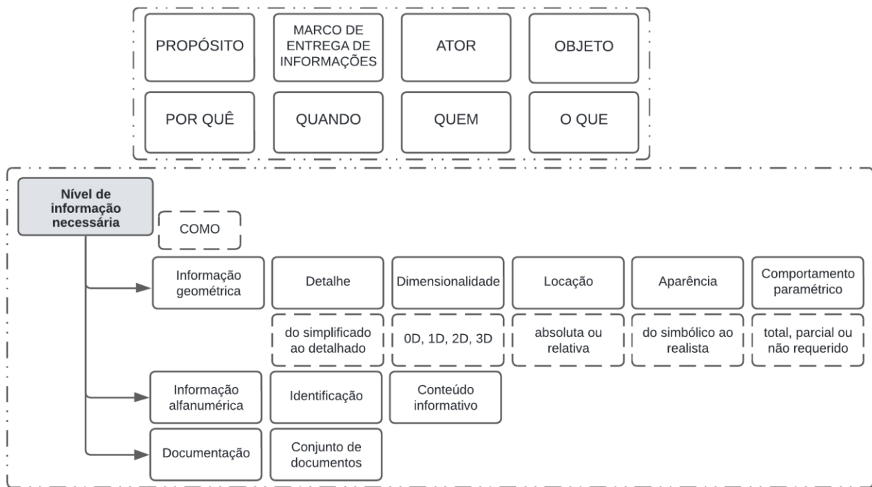
Figura 1: Diagrama de relacionamento sobre o nível de informação necessária. Fonte: adaptada de ISO 7817-1:2024.
