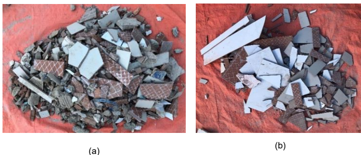
Figura 3: Processo de triagem no Canteiro experimental da FAU-UFRJ: (a) O resíduo 'in natura', conforme removido do ponto de descarte no Itanhangá e (b) após triagem.
