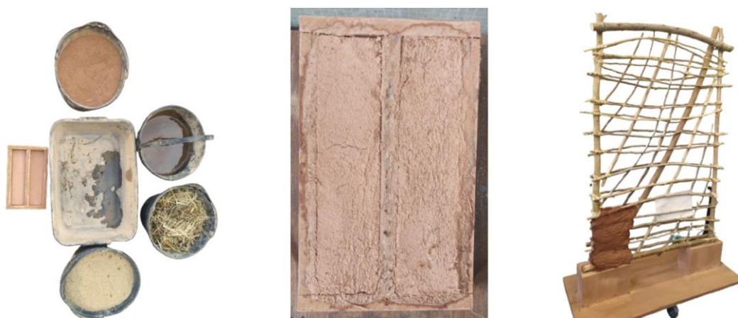
Figura 5: Traço da mistura teste, molde de retração (mistura sem fibras à esquerda, mistura com fibras à direita) e fixação da mistura teste na parede. Fonte: os autores (2023).
