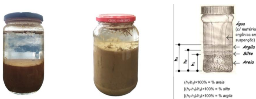
Figura 1: Teste do vidro com o solo utilizado na mistura.
