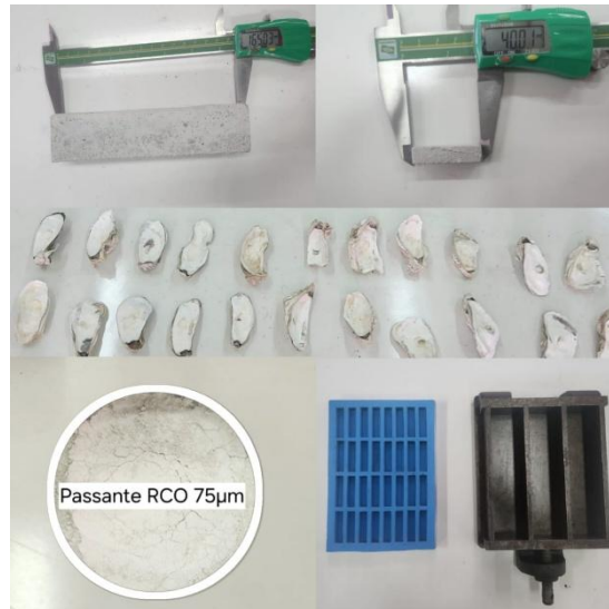
Figura 2: Detalhes dos Corpos de Prova, Resíduo de Concha de Ostra (RCO) e Moldes Empregados. Fonte: Os autores (2025).
