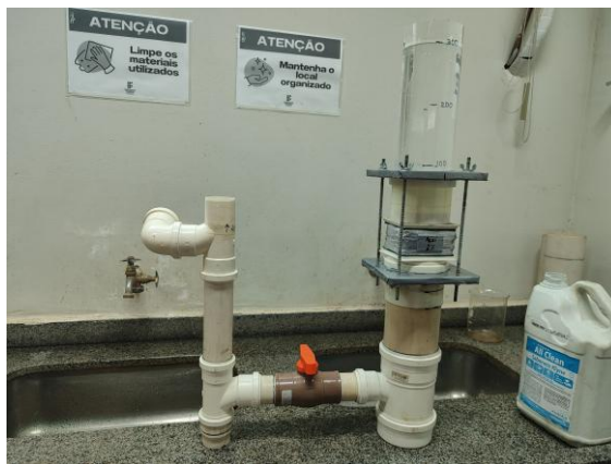
Figura 1: Dispositivo utilizado nos ensaios de permeabilidade à água dos concretos permeáveis.
