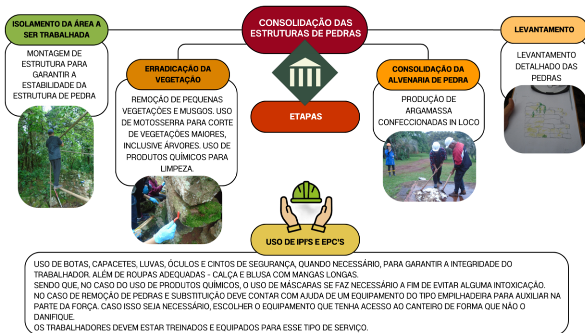
Figura 3 - Etapas do Restauro. Fonte: Os autores (2024).
