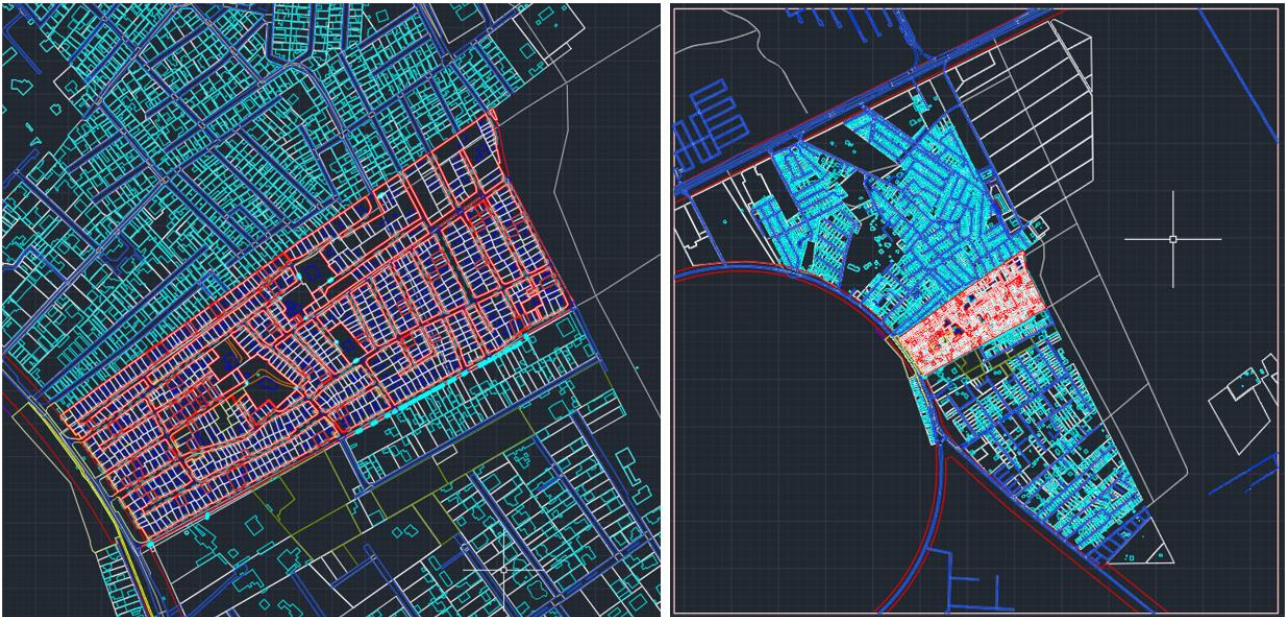
Figura 1: Vetorização no software Autodesk Civil 3D 2025 com inserção de atributos em objectdata . Fonte: os autores (2025).
